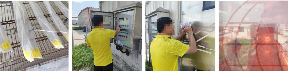
3. 温度探头置于物资表面，人员退出，开启设备，填写记录表，查看烘干房是否工作。
